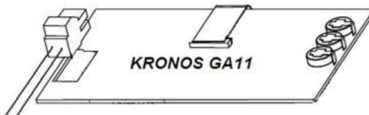
Podłączenie z płytą sterowania w nagrzewnicy powietrza
