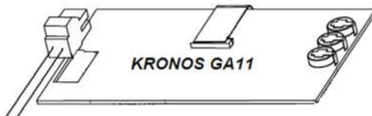
Podłączenie z płytą sterowania w nagrzewnicy powietrza
